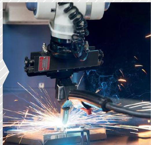
fabricación automatizados, máquinas-herramientas gobernadas por control numérico y robots industriales.
