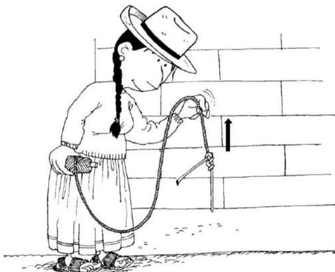
8. Envuelve las dos caras de la pared y la viga collar con la cuerda vertical. Amarra los extremos usando el nudo 8 y los dos nudos simples, como en los pasos anteriores.
