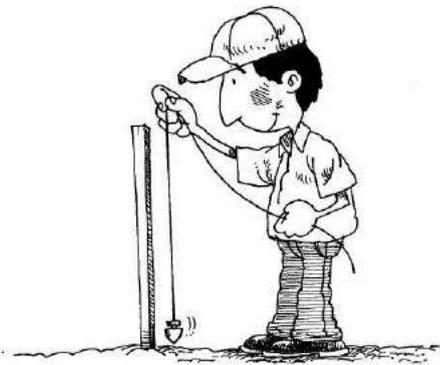
2. Coloca estacas en todo el terreno y verifica que estén a plomo (verticales).
